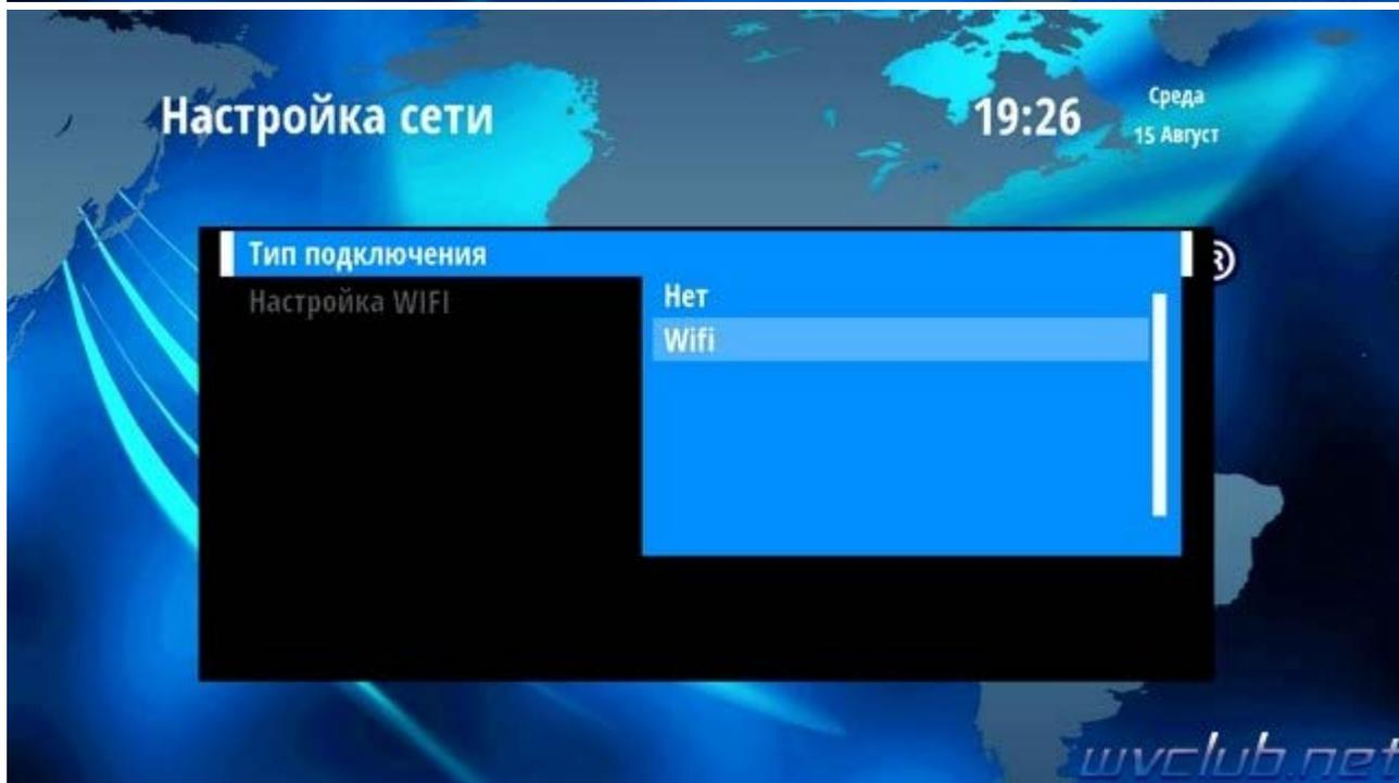
Тип подключения выбираем **Wi-Fi** и переходим в следующую строку "**Настройка WIFI**", в следующем меню будут отображаться имена **SSID** найденных беспроводных точек доступа, определяем свою по имени или качеству сигнала который можно увидеть в нижней части экрана по цветным шкалам и выбрав **SSID** курсором при помощи джойстика пульта ду нажимаем кнопку **OK**.
