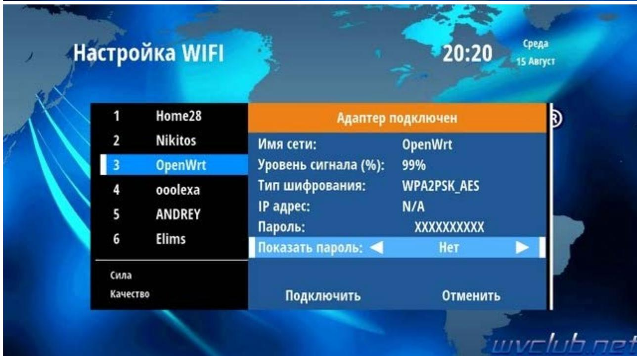
После успешного подключения к сети можно переходить в приложение IPTV плеер, хочу обратить внимание что **IP-адрес** присваивается только по **DHCP**, то бишь автоматически, но в в вашем роутере должен быть активен данный сетевой протокол.
