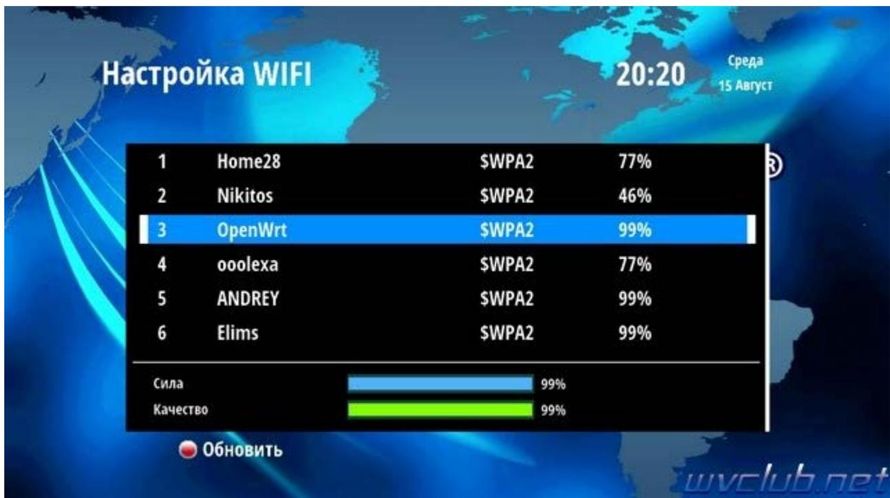
Если сеть имеет шифрование, то в следующем графическом окне вам потребуется ввести пароль для подключения к сети, ввод производится посредством джойстика пульта ДУ и виртуальной экранной клавиатуры.
